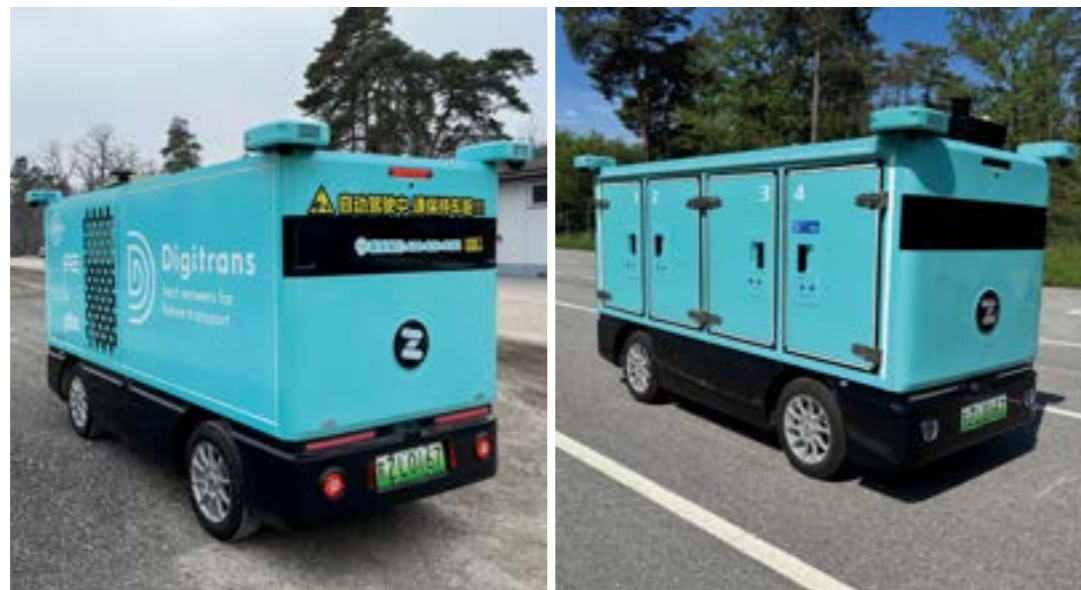
Abbildung 6: Automatisiertes Fahrzeug aus China, welches im Zuge des AURORA Projekts intensiv getestet wurde, mit Ansicht der Ladefächer ©DigiTrans GmbH
